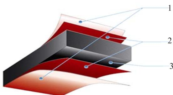
1. слой – защищающий от механического воздействия
